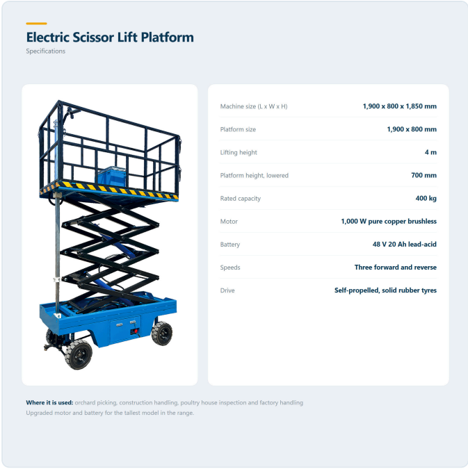
图 3-2 整机尺寸与规格标注 Fig. 3-2 Overall dimensions
